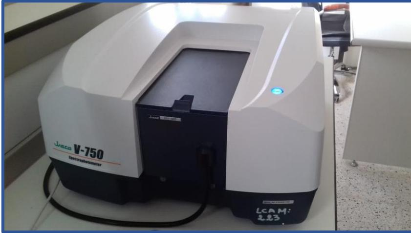
الشكل (14.II): صورة فوتوغرافية للجهاز المستعمل في التحليل الطيفي للأشعة فوق البنفسجية و المرئية.
