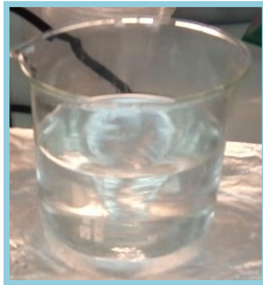
شكل II.3. مظهر محلول الرش (إذابة خلات أكسيد الزنك في الميثانول بعد عملية الخلط بالتأثير المغناطيسي).
