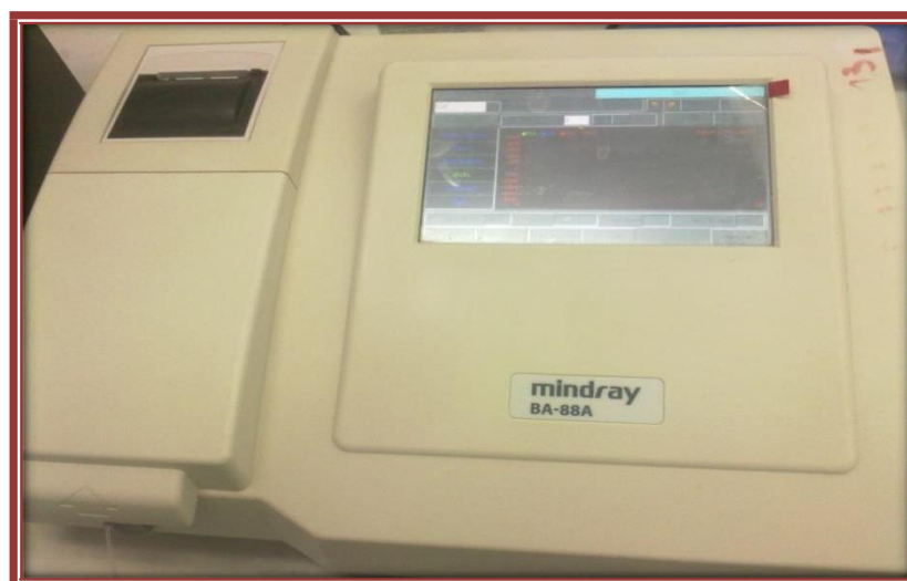
Figure 06: Spectrophotomètre de marque ERMA Mindray BA-88A (photo personnelle).
