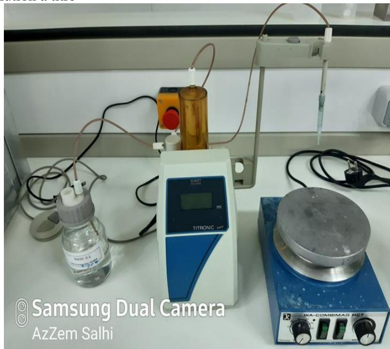
**Figure 16.** Appareil de titrage automatique « TITRONIC » utilisé pour mesurer l'acidité titrable de « Lagmi »
