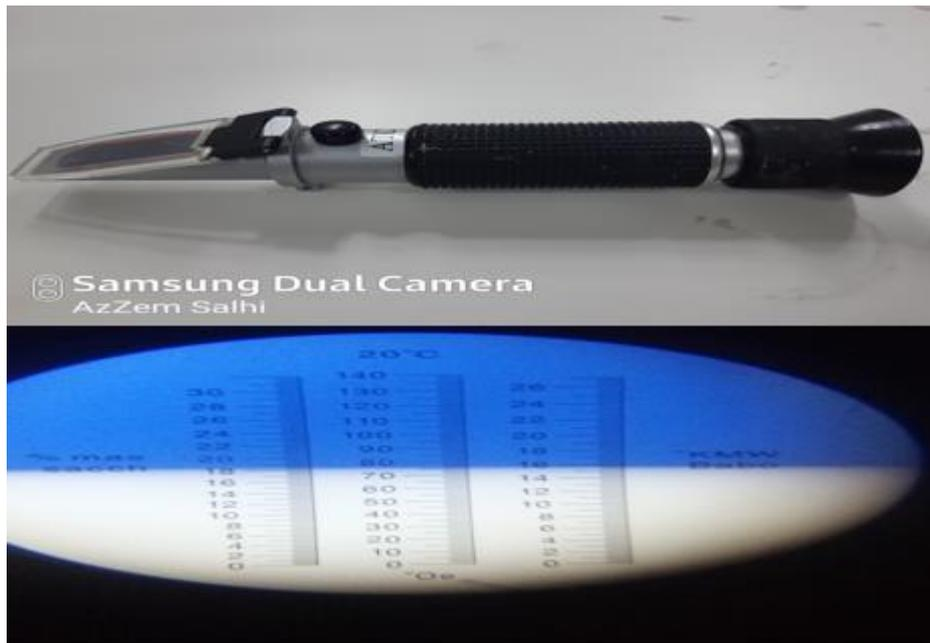
**Figure 17.** Réfractomètre « ATC, HANDHELD » utilisé pour mesurer la matière sèche de « Lagmi »
