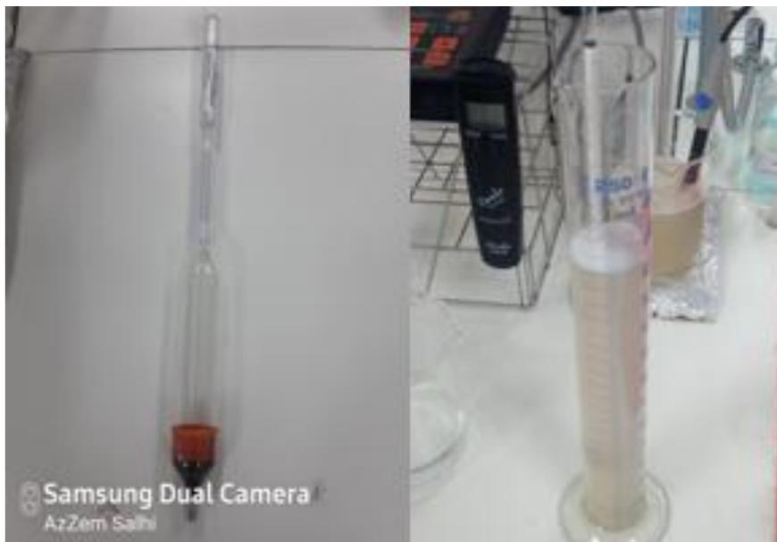
Figure 20. Densimètre utilisé pour mesurer la densité de « Lagmi »
