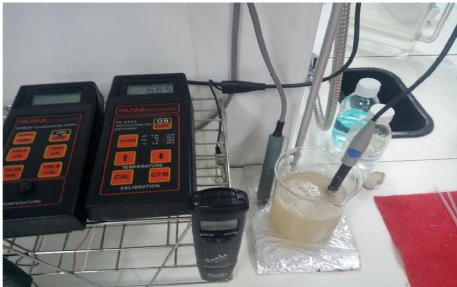
**Figure 15.** Potentiomètre utilisé pour mesurer le pH de « Lagmi »
