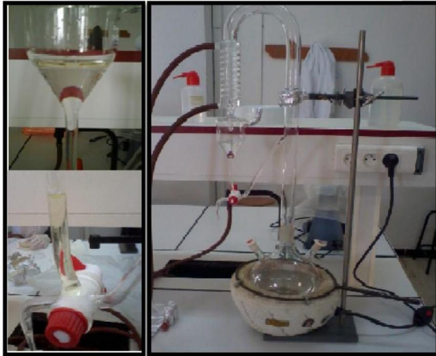
**Figure 07 :** Montage de l'hydrodistillateur de type CLEVINGER.
