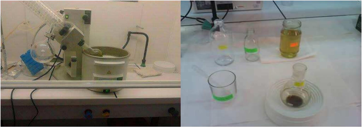
**Figure 16 :** Représentant la technique de la concentration de filtrat dans un appareil de rotavapeur (photo personnelle).
