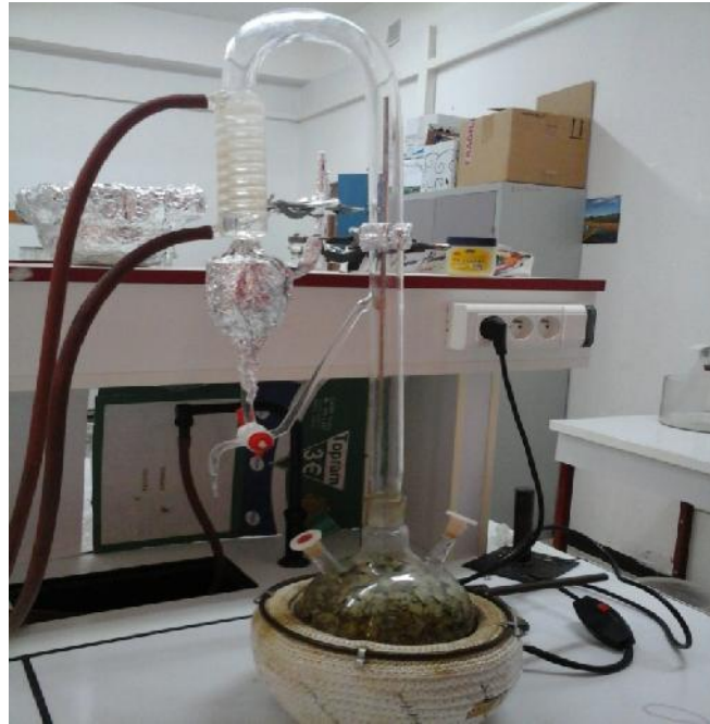
Figure 07 : Hydrodistillateur de type Clevenger (Photo personnelle).
