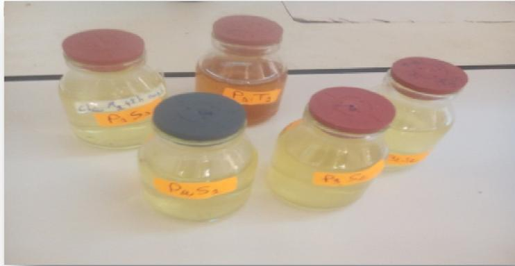
**Figure 11 :** Quelques Bouteilles d'échantillons après l'étape de la minéralisation
