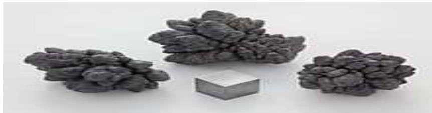
Figure 10 : Nodules de Plomb, raffinés par électrolyse, à côté d'un cube d'1 cm 3 de Plomb pur à plus de 99,9 % ( Bodek et al., 1998 ).
