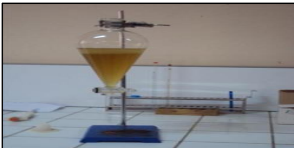
Figure 11: Extraction liquide-liquide à l'aide d'une Ampoule à décanté
