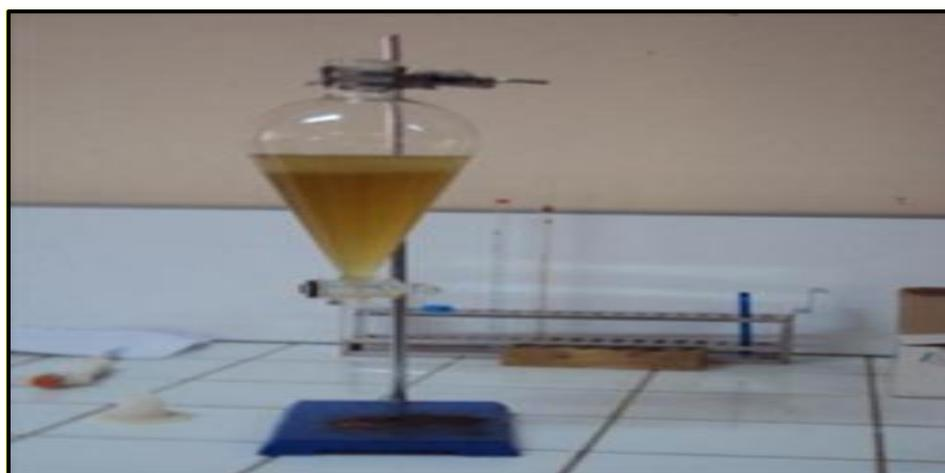
**Figure 23:** Extraction liquide-liquide à l'aide d'une Ampoule à décanté
