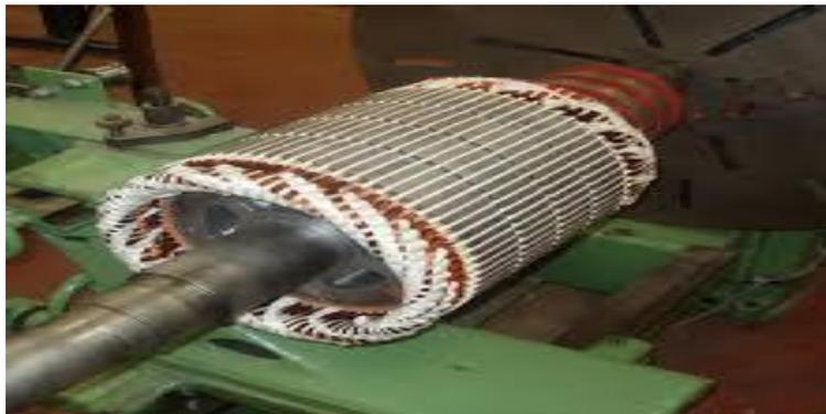
**Figure (II.04)** : photo d'un rotor bobiné d'une MAS
