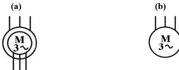
Figure (II.03) : Symboles électrique du moteur asynchrone à rotor bobiné (a) Et à cage d'écureuil
