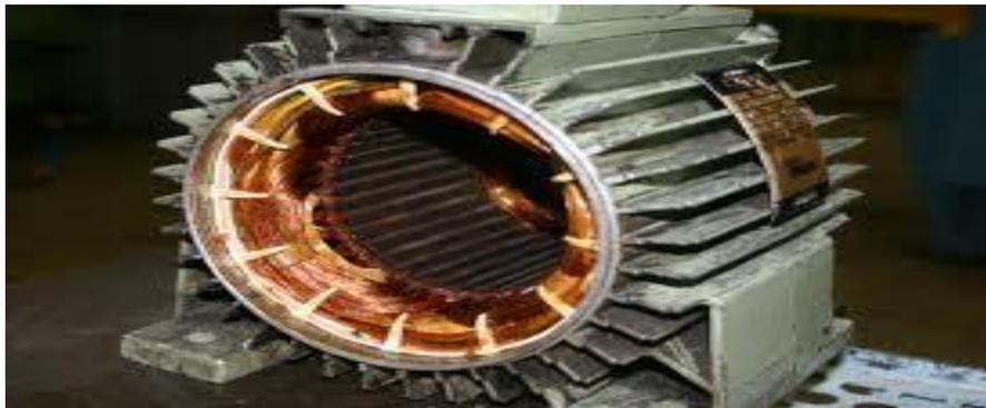
Figure (II.02) : photo d'un stator d'une MAS
