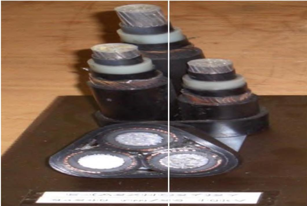
Figure (3.3) Constitution d'un câble Tripolaire.
