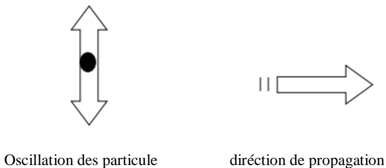
Figure II.08 Oscillation des particule et diréction de propagation[06].
