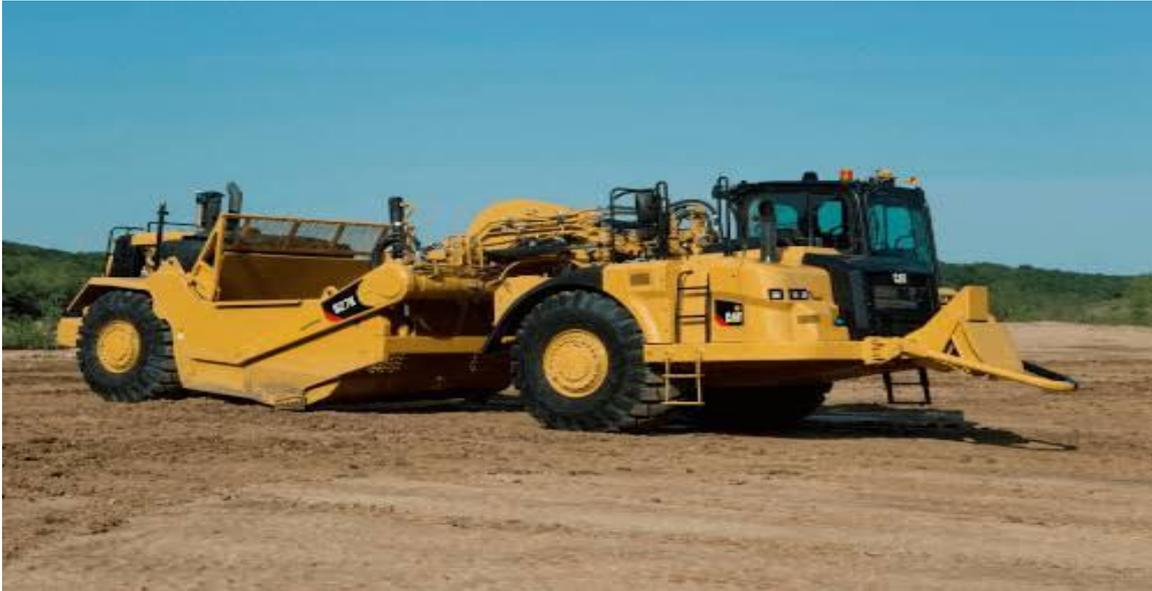
**Fig.2.3.** Décapeuses ou scrapers [19]
