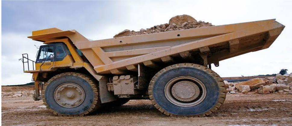
**Fig.2.4.** Tombereaux à châssis rigides [19]
