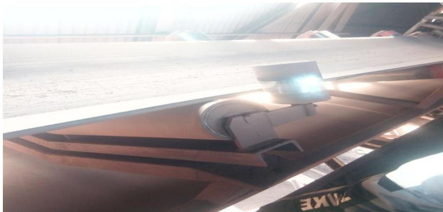
**Fig.4.13.** La bande avec les rouleaux supérieurs et de guide [prise de la photo]
