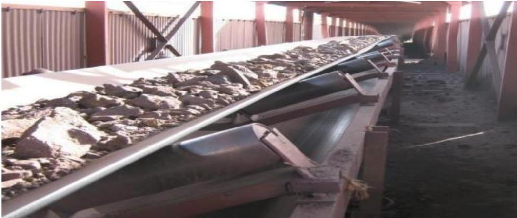
**Fig.4.10. Convoyeur à bande [prise de la photo]**
