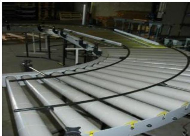
Fig.3.8. Convoyeur à rouleaux conique [48]
