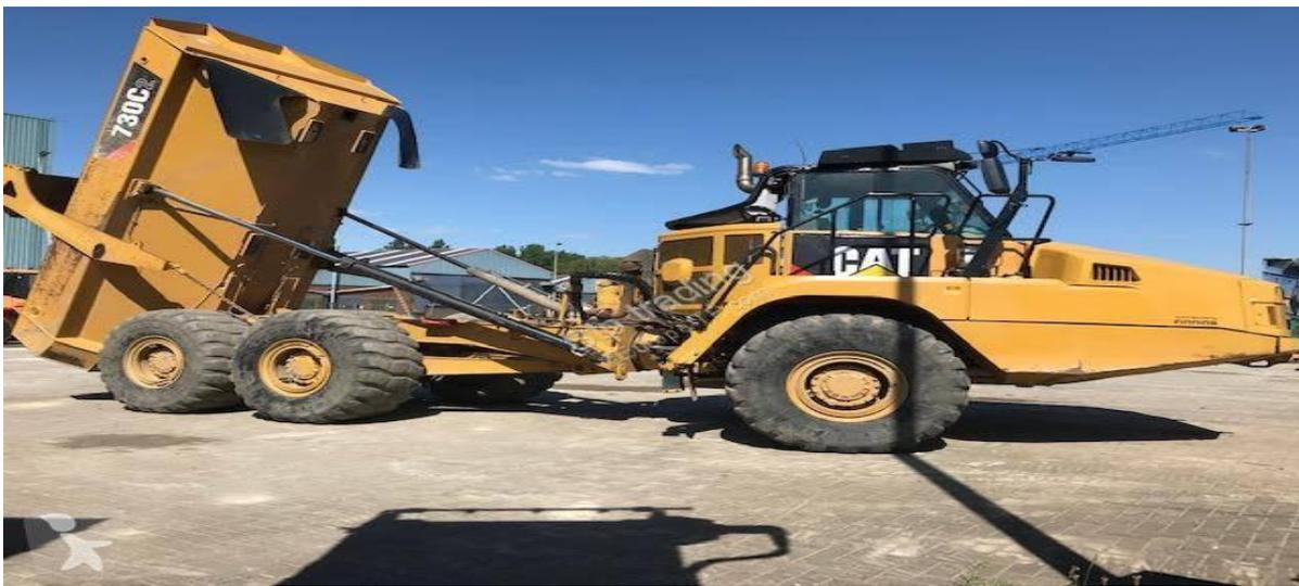
**Fig.2.5.** Les tombereaux à châssis articulés [19]
