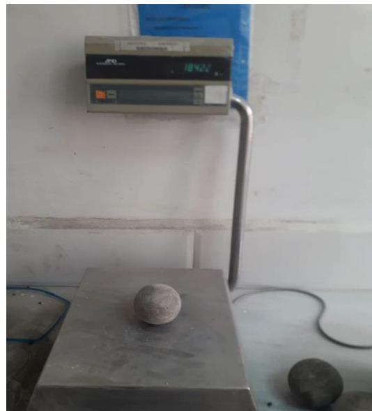
Figure.4.7 : Une boule (80mm) avant et Après l'usure
