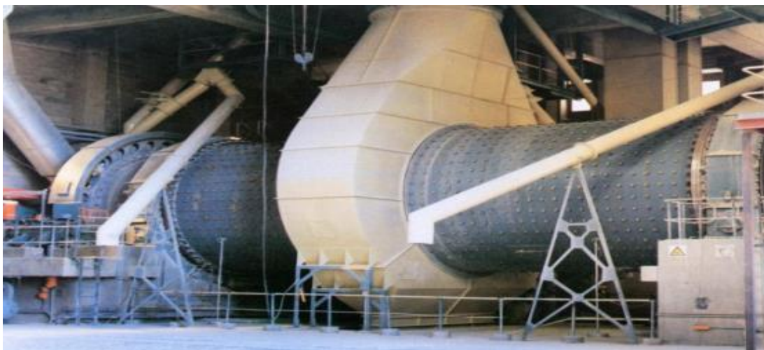
Figure 3.3 : broyeur à décharge centrale
