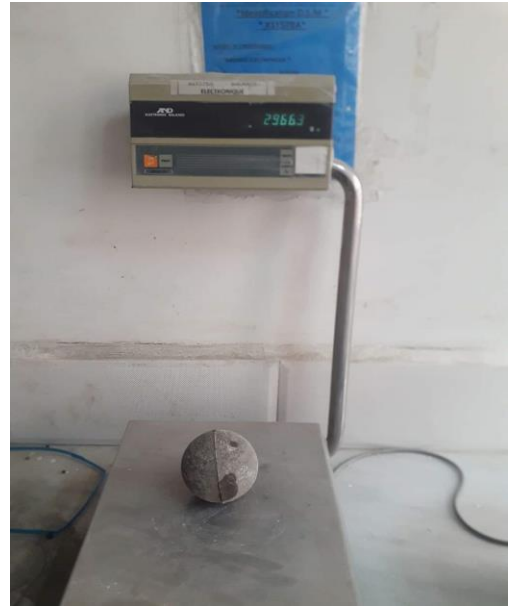
Figure.4.6: Une boule (90mm) avant et Après l'usure
