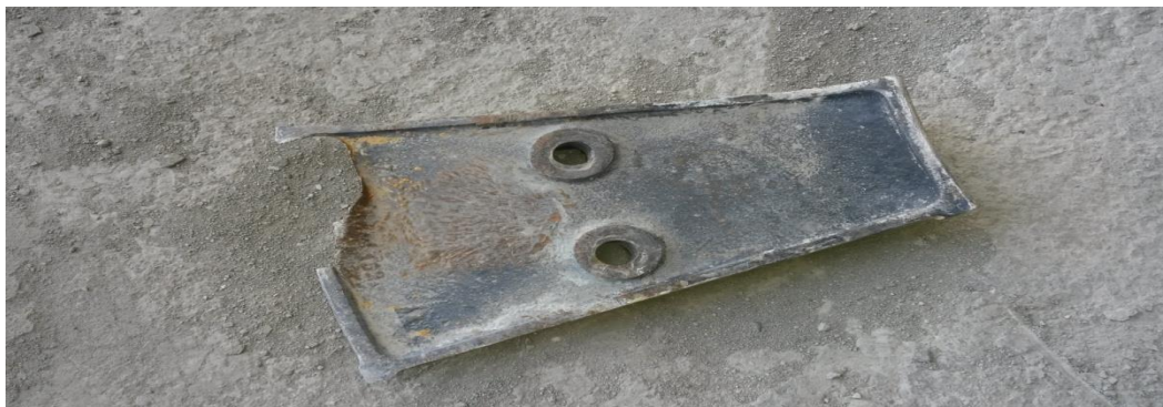
Figure.4.4 : Des plaques de blindage après l'usure
