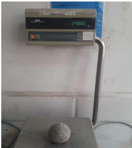
Figure.4.7 : Une boule (80mm) avant et Après l'usure
