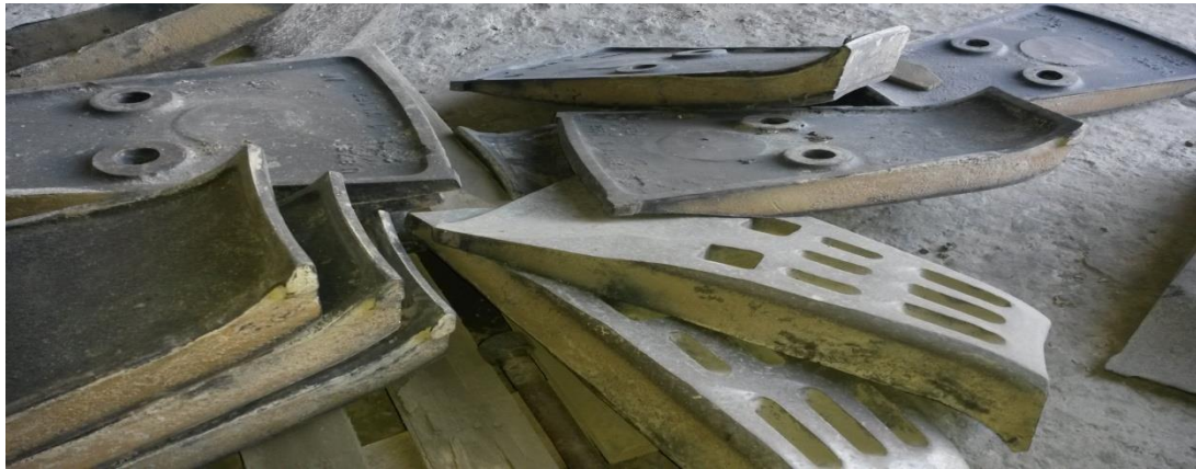
Figure.4.5 : Des plaques de blindage avant l'usure
