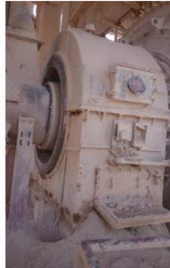
Figure.3.15 : palier de sortie et d'entrée
