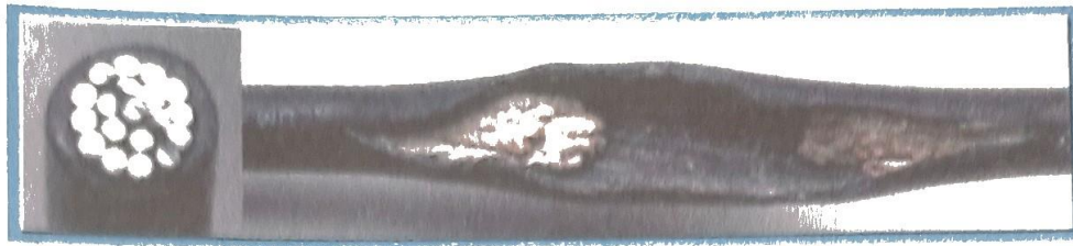
Figure 2.14 : câble d'aluminium endommagé suite à la corrosion par l'eau
