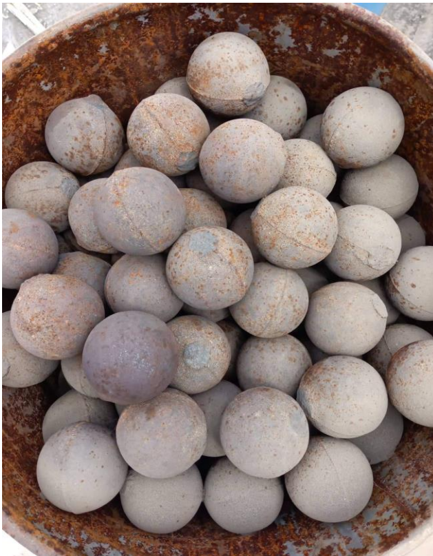
Fig.4.1: Boulets de broyage : 10 à 90 mm
