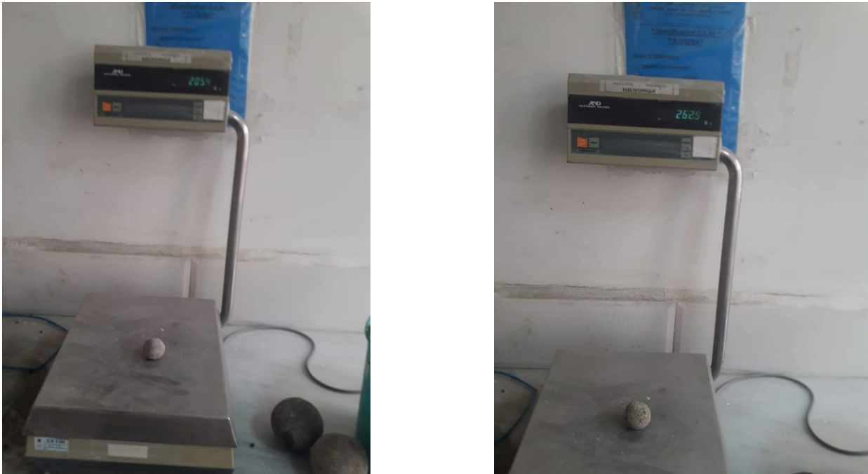
Figure.4.8 : Une boule (40 mm) avant et Après l’usure
