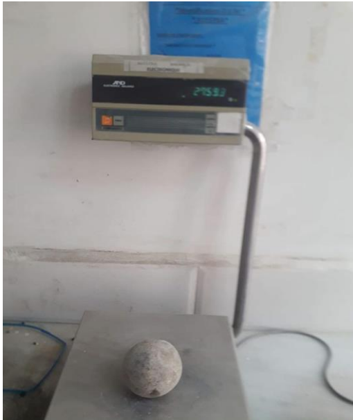
Figure.4.6: Une boule (90mm) avant et Après l'usure
