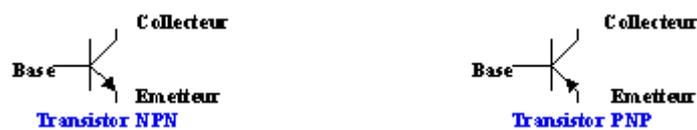
Figure (II.4):Le transistor BJT
