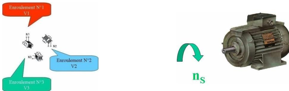
**Figure II.5** Le champ tournant résultant tourne dans le sens Horaire à la vitesse  $n_s$
