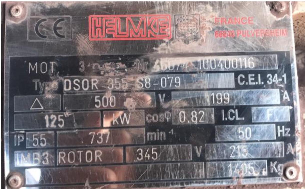
**Figure .V.1.**Plaque signalétique de MAS 125 KW
