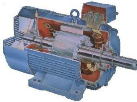
**Figure II.1** Coupe montrant les différentes parties constituant un moteur asynchrone [3].
