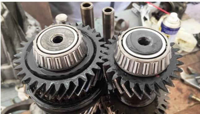
**Figure 4.20.** *Roulement boîte à vitesse*
