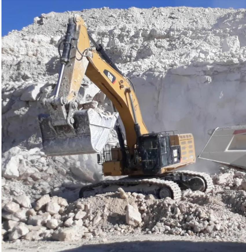
**Figure 4.4.** *Pelle hydraulique CAT 390 F*
