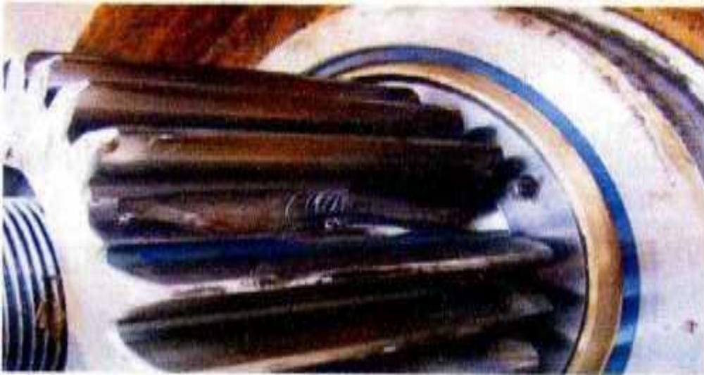
**Figure 2.16** : Défauts réels d'engrenage localisé. [35]
