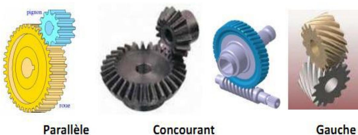
**Figure 2.15** : Différents types d'engrenage. [35]
