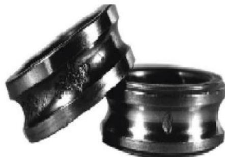
Figure I.11: Défaut sur la bague intérieure [11].
