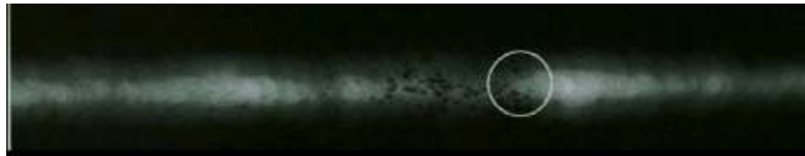
Figure 84 : Image radiographique des nids de soufflures.
