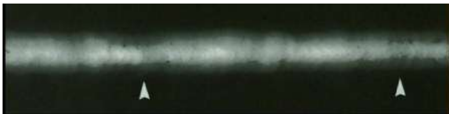
Figure 82 : Image radiographique de la soufflure sphéroïdale.
