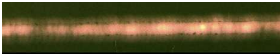
Figure 96 : Image radiographique de manque fusion des bords.
