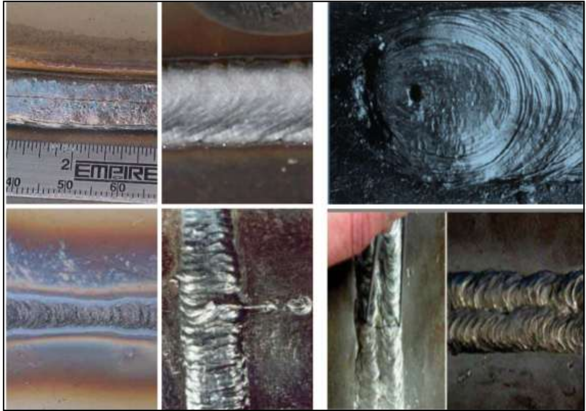
Figure 64 : Défauts de soudage.
