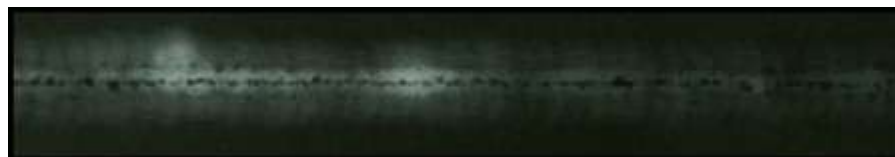
Figure 86 : Image radiographique de soufflures alignées à la racine du joint.
