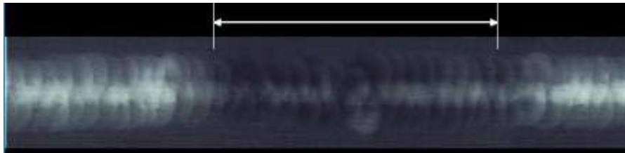
Figure 110 : Image radiographique de concavité excessive.
