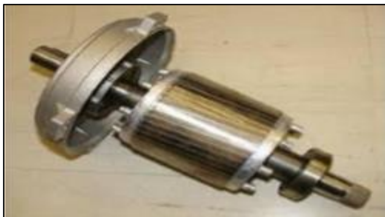
Figure I. 4: Rotor à cage d'une MAS. [6]
