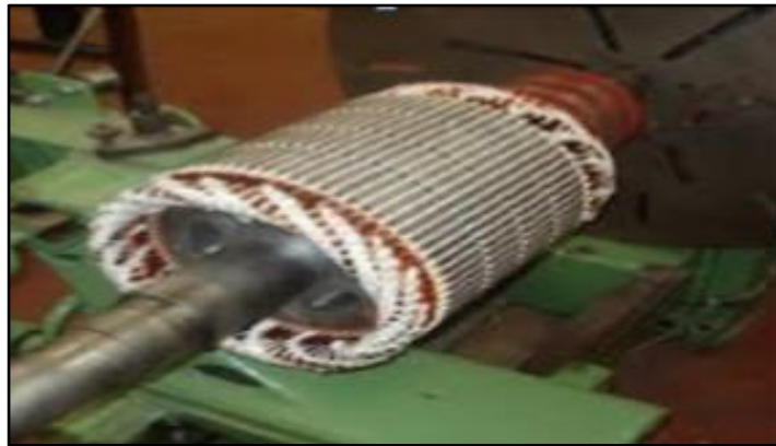
Figure I. 3: Rotor bobiné d'une Machine asynchrone. [6]
