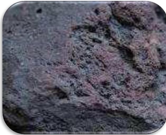
**Figure I.9** Minerai de magnétite
