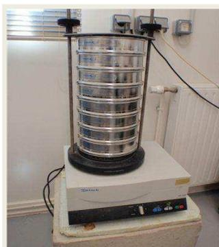
**Figure IV.4.** Tamiseuse Resch
