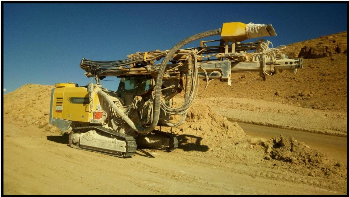
**Figure III 2 :** Sondeuse Atlas Copo T35
