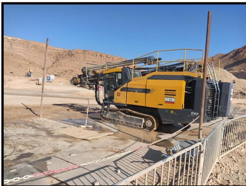
**Figure III 1 : Sondeuse Atlas Copco D 50**
