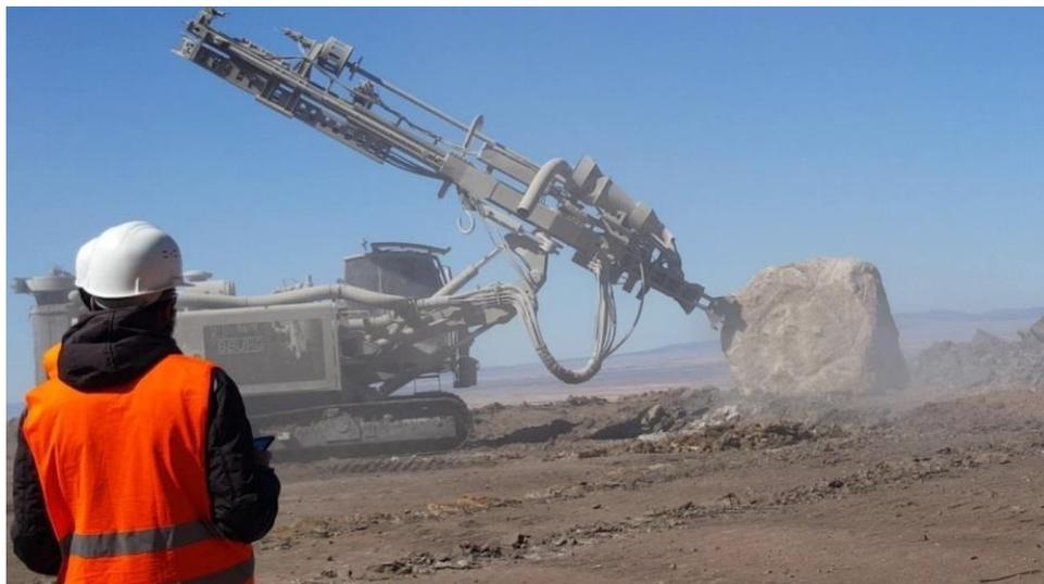
**Figure. II .1.13.** la sondeuse BBURG HD1500D utilisé pour les travaux de forage au niveau de la mine de Boukhadra
