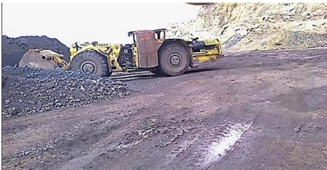
**Figure .II.2.6:** chargeuse transporteuse pneumatique type ATLAS COPCO St 1020.
