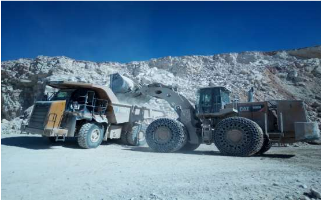
Fig n° 13 : l'ensembles de chargement-transport .
