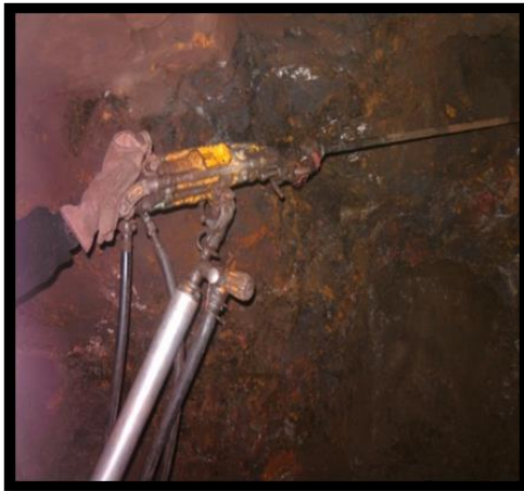
Figure 9 : Marteau perforateur utilisé dans la mine de Boukhadra. [7]
