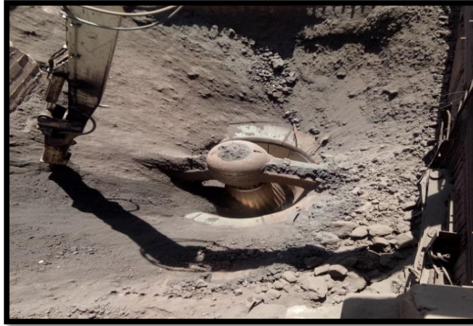
Figure 5 : Traitement mécanique réalisé par le concasseur giratoire.
