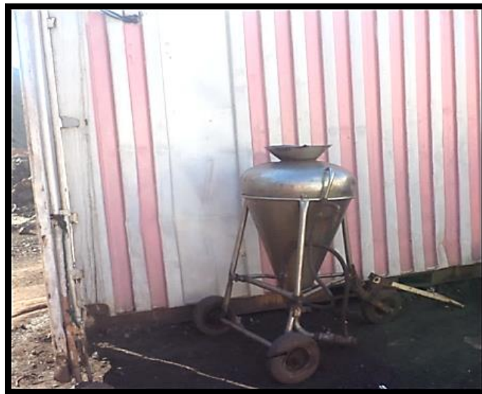
Figure 12 : Machine de chargement des trous. [7]
