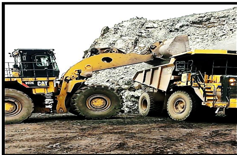
Figure 4 : Chargement et transport par Chargeuse Caterpillar 990K et Camion Caterpillar 75G.
