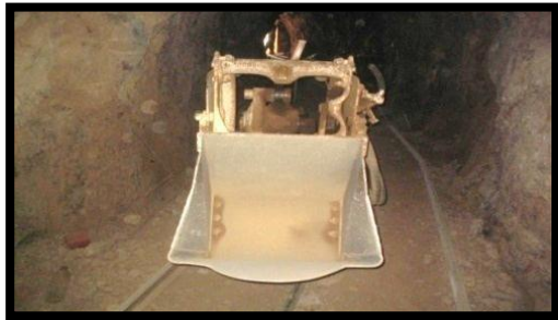
Figure. III.10 : Pelle sur rail de chargement
