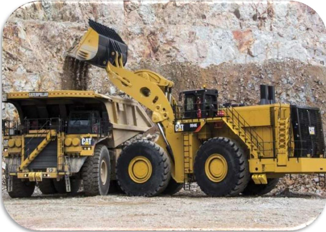
**Figure III.14 :** Chargeuse sur pneus en butte en position de chargement
