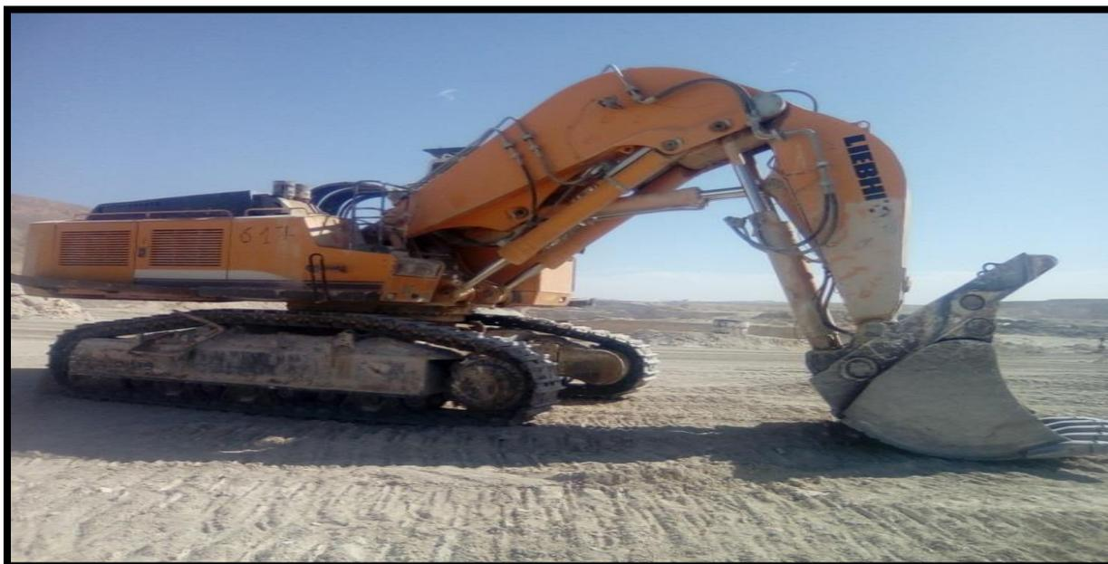
Figure III.17 : Pelle hydraulique en butte LIEBHERR R974C
