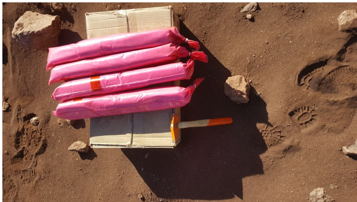
Figure 08 : Explosif encartouché de type Marmanite
