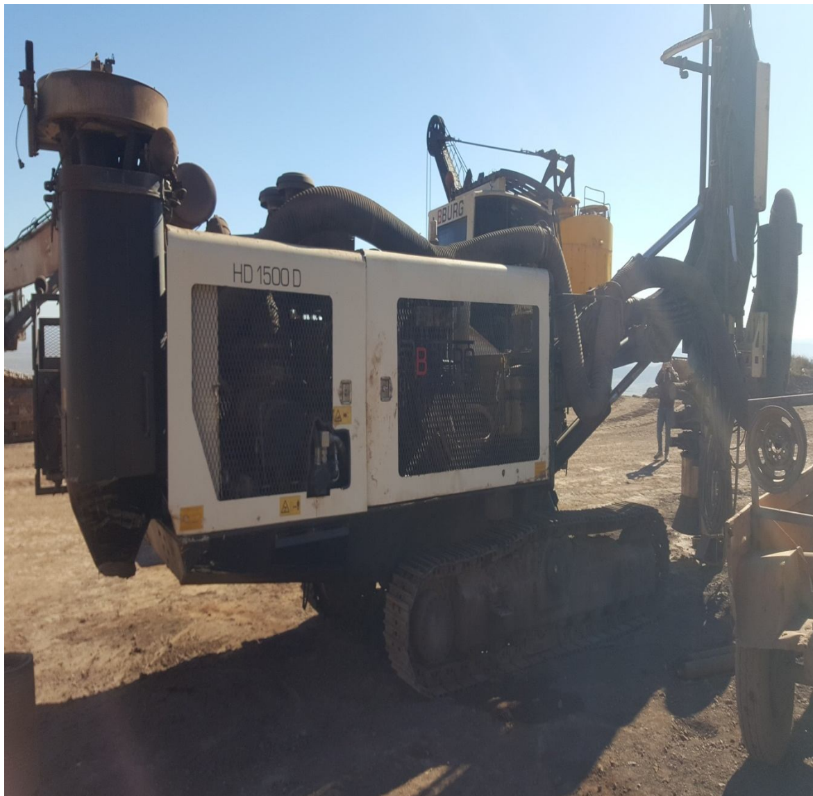
Figure07 : La Sondeuse BBURG HD1500-D utilisée pour les travaux de forage au niveau de la mine d'Ouenza en activité.
