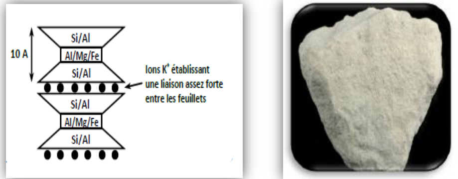
Figure I. 15 : Structure élémentaire de la Montmorillonite [13]
