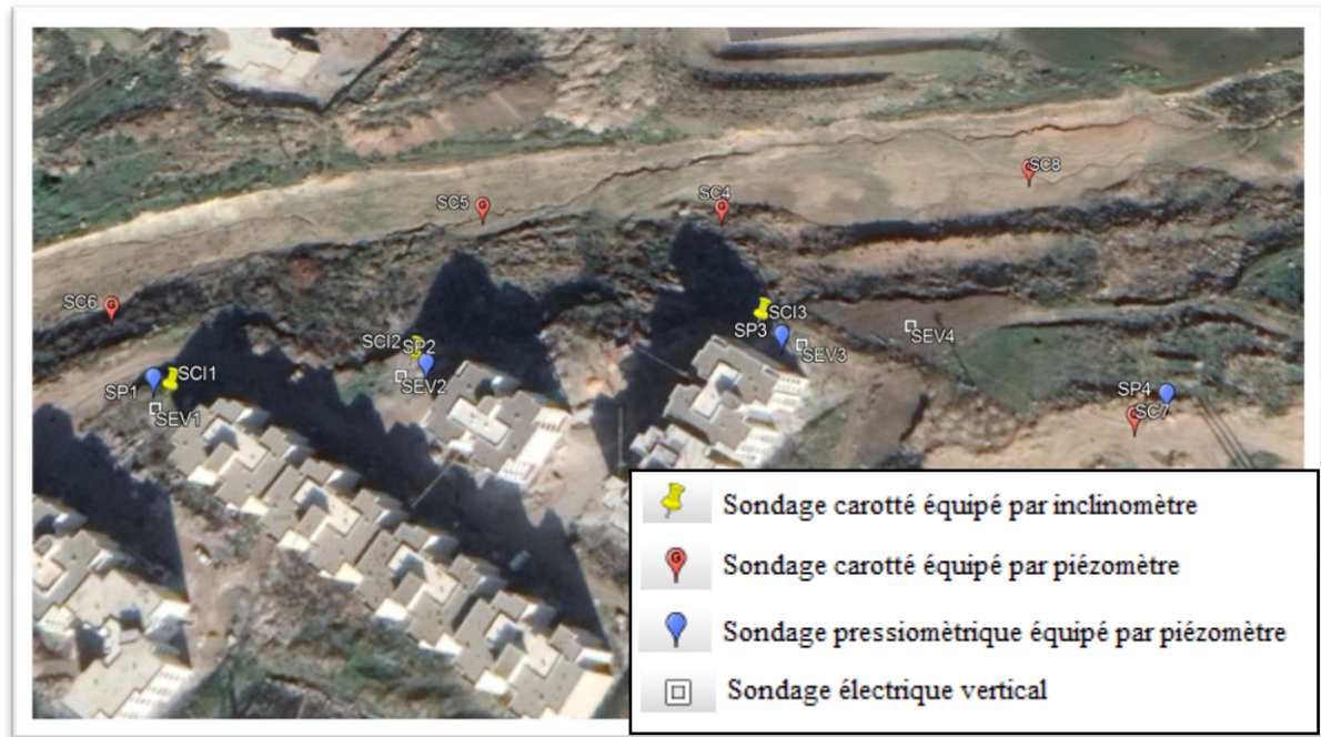
Figure IV.26: Plan d'implantation de l'investigation géotechnique In situ [44]
