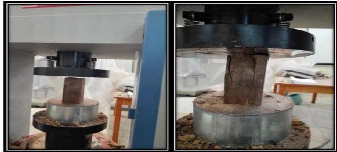
Figure III.25. Essai à la compression simple. (Ben youcef et Mansouri, 2016).
