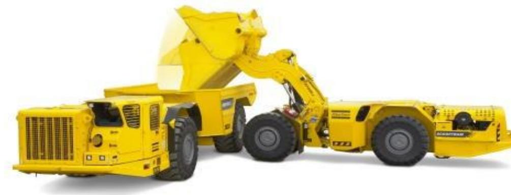
Figure III.15. Chargeuse et transporteur souterrain. (Azouz, 2019).
