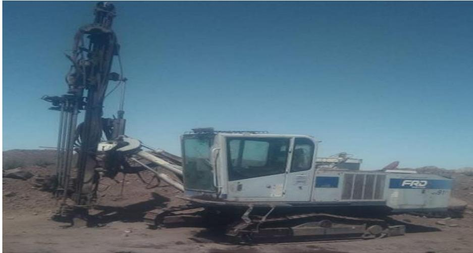
**Figure III.10.** Sondeuse INGERSOLL-RAND, de type T4-BH900.
