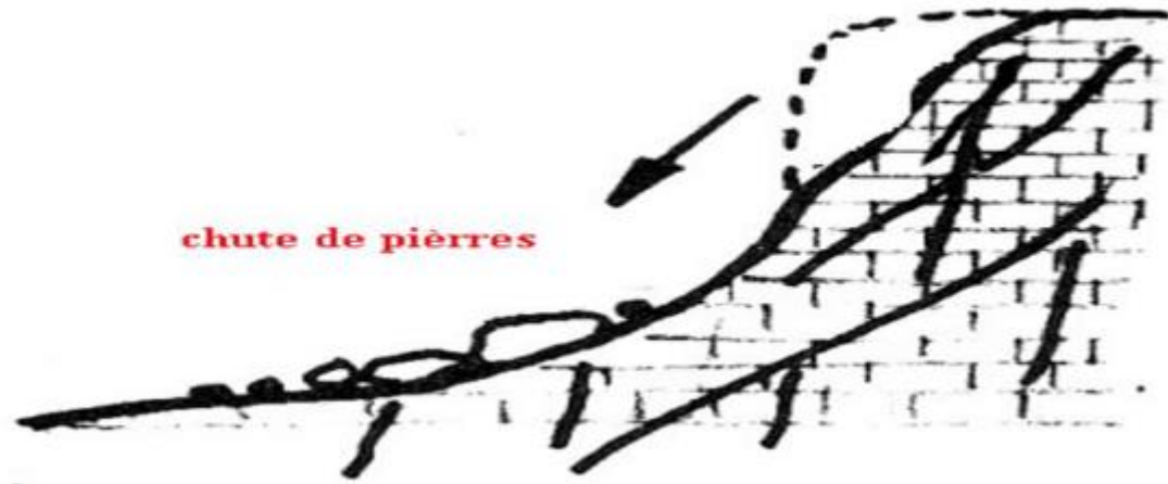
FigureI.9: Chutes de pierres et de blocs. [11]
