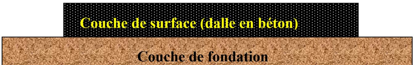
Figure 1-4 Structure type d'une chaussée rigide.
