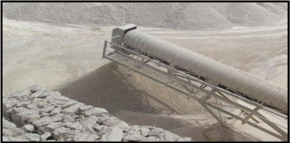
**Figure III.3 :** Le transport du minerai par convoyeur à bande.
