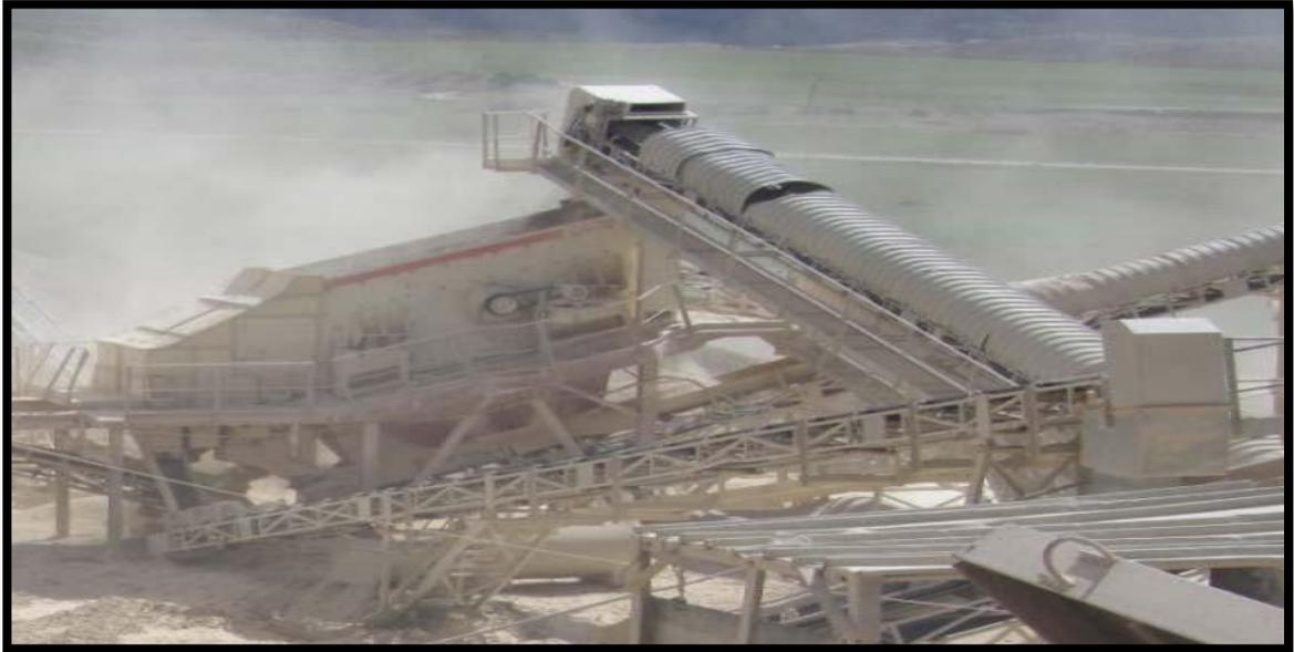
**Figure III.6 :** Transport de la charge par convoyeur.
