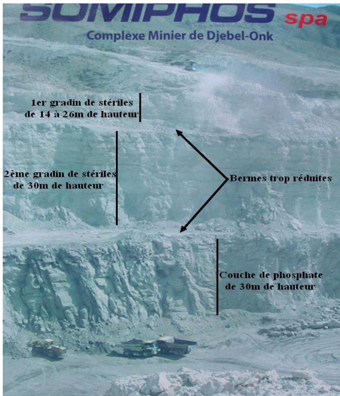
Figure III.19 - Photo montrant les dimensions des fronts d'exploitation.
