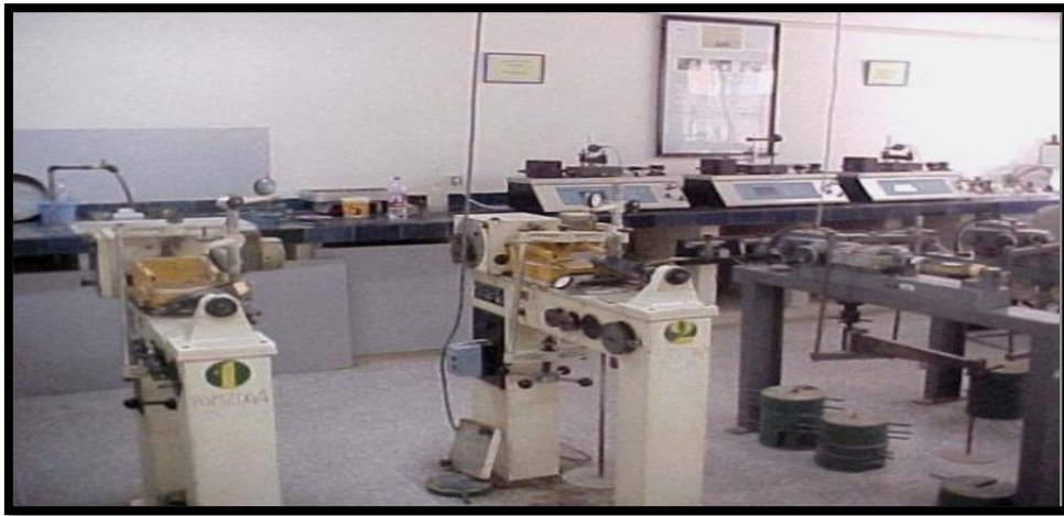
Figure.25: Dispositif de l'essai de cisaillement a la boite.[3]
