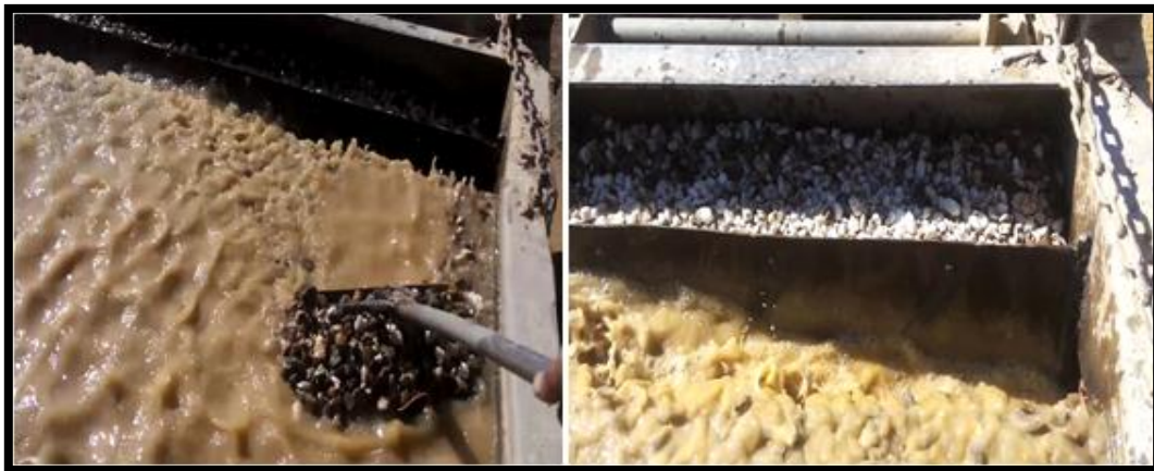
Figure II.04 : séparation gravimétrique du minerai barytique de Ain Mimoun Khenchela –Algérie-
