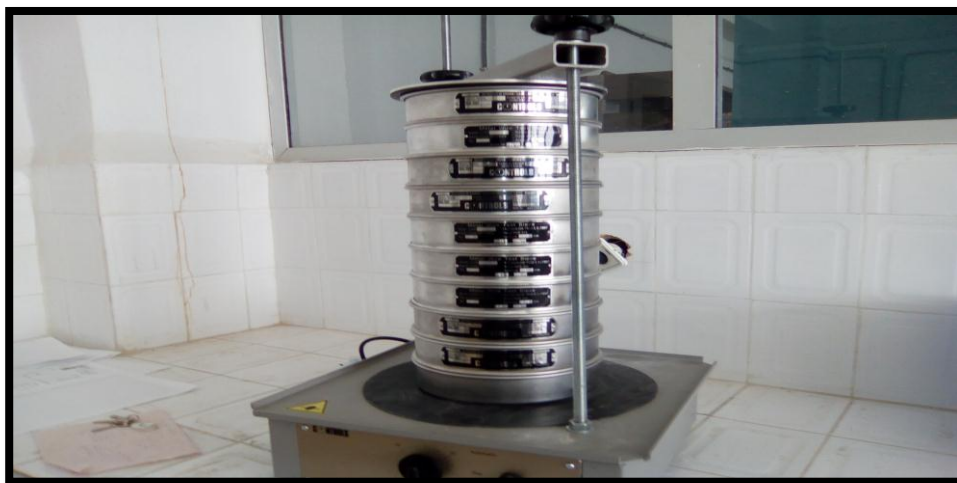
Figure IV.04: Tamiseuse électro-vibrante de laboratoire des mines
