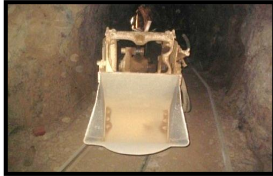
Figure I.07 : Pelle sur rail de chargement
