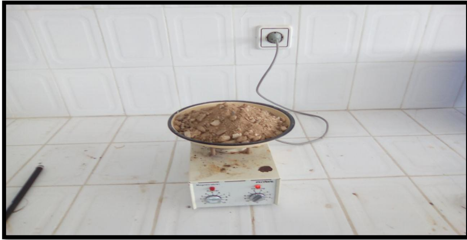
Figure IV.03 : Photo qui montre le séchage du matériau avant le tamisage
