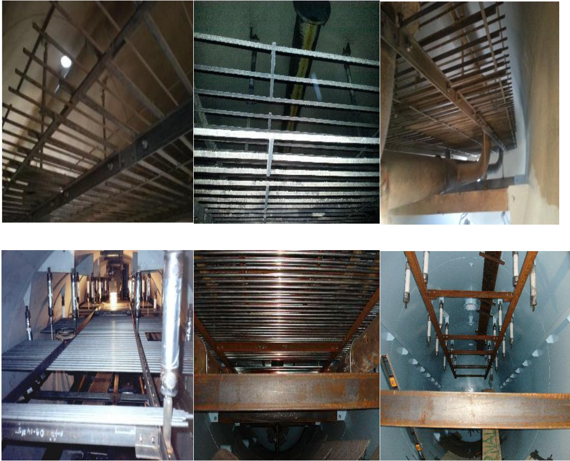
Figure III-6 : Les électrodes du dessaleur [20]
