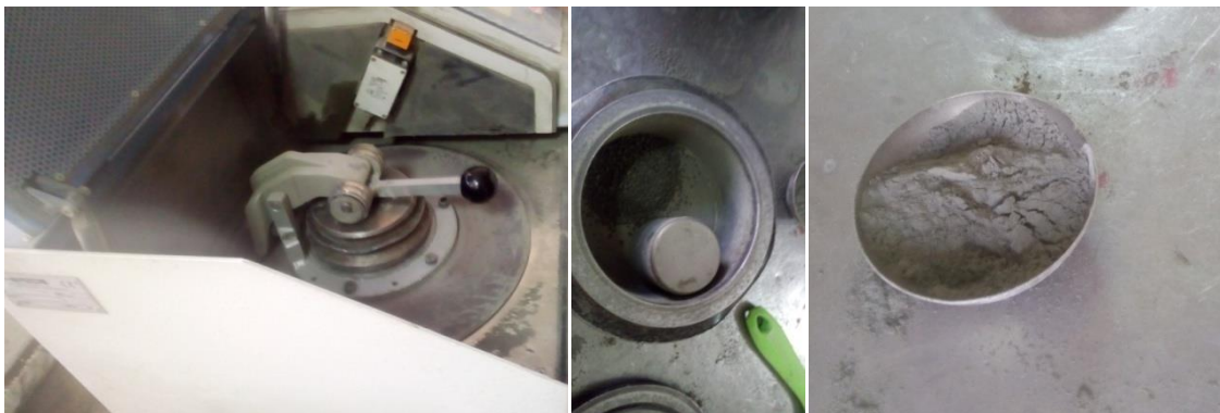
Fig III-09: Broyage du clinker.
