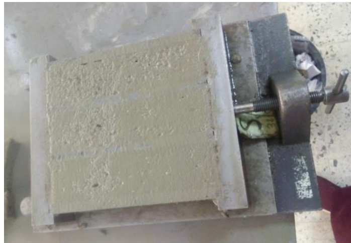
Fig III-20: Surplus du mortier arasé.
