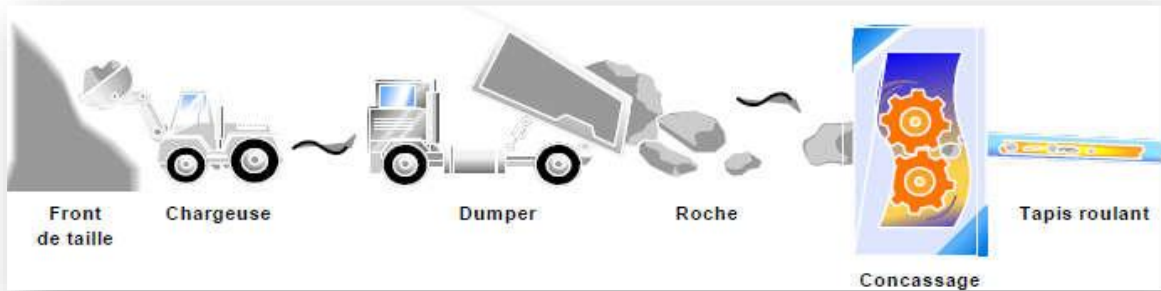
Fig I-05: L'extraction des matières premières.
