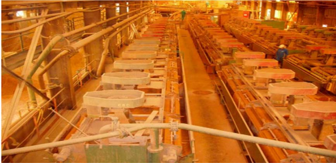
Figure.I.4 : Cellules de flottation dans l'usine de Chaillac. [02]
