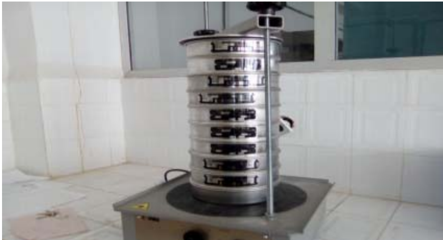
Figure IV.01: Tamiseuse électro-vibrante de laboratoire des mines. [12]
