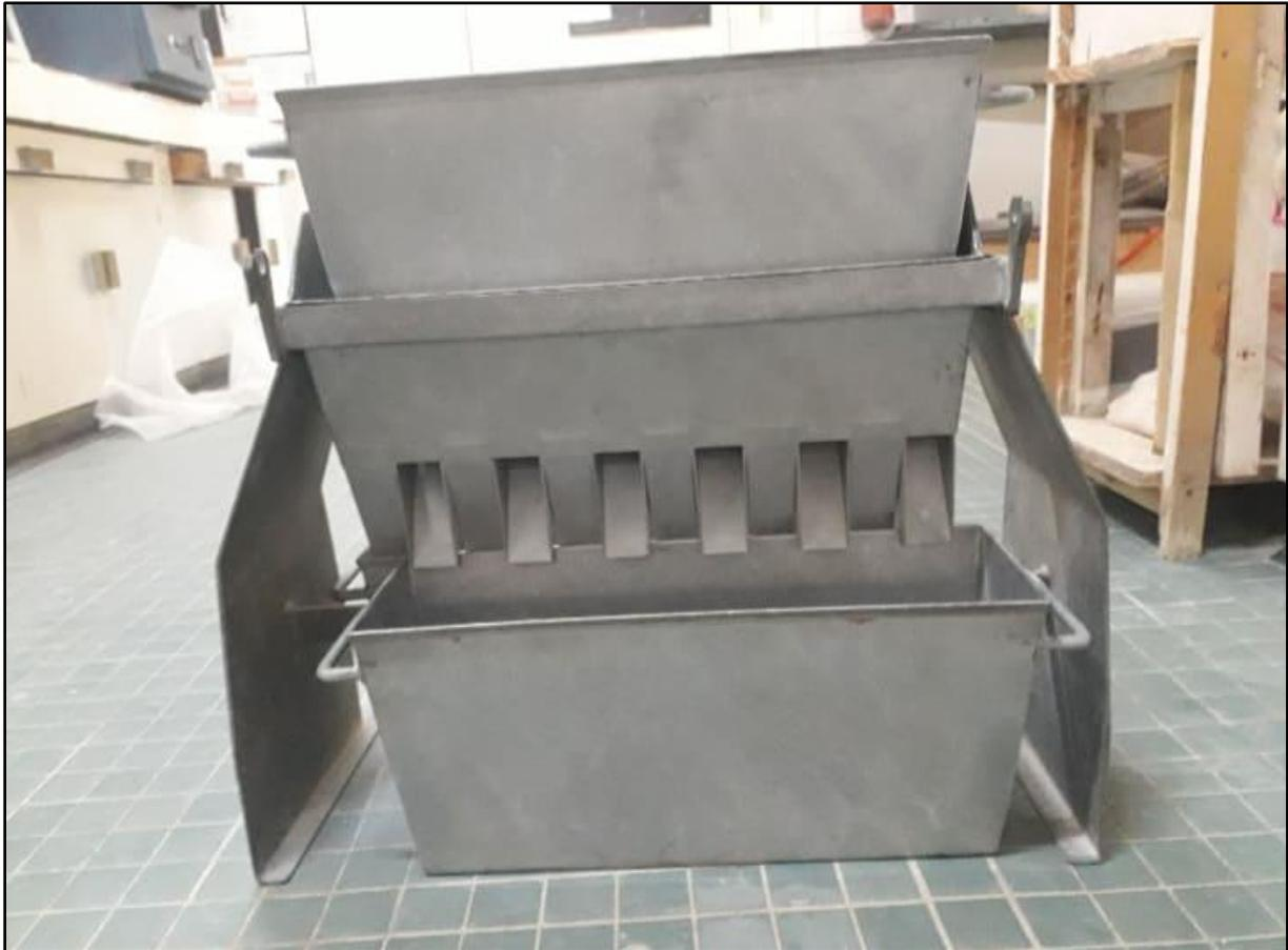
**Figure 16 :** Photo d'un Diviseur manuel au Labo de Bir El Ater
