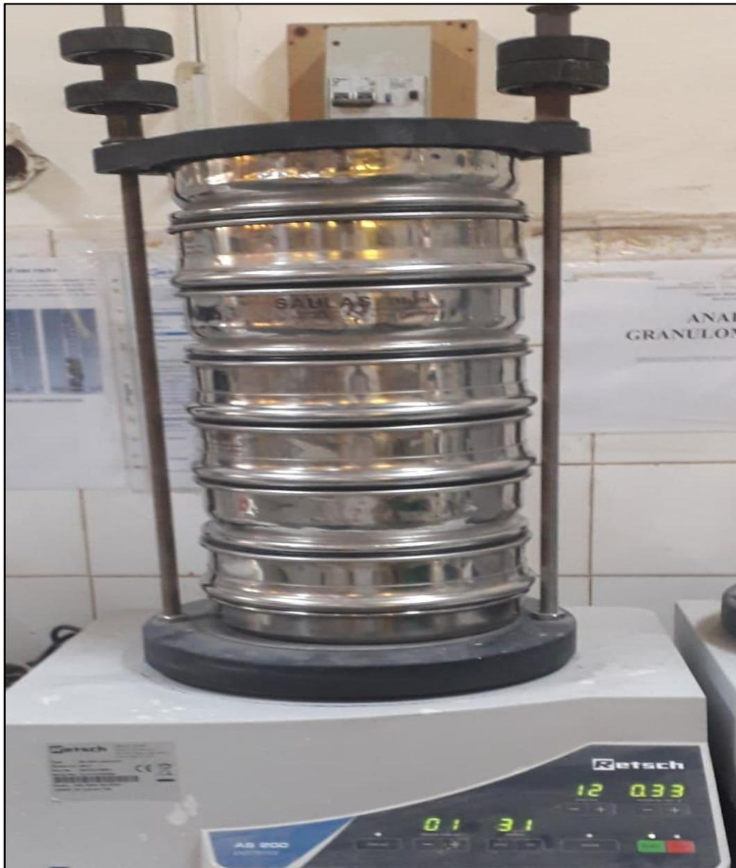
**Figure 18** : Photo d'un Tamiseuse électrique au Labo de Bir El Ater
