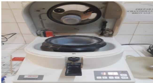
**Figure 19** : Photo d'un Broyeur à mortier Pulverisette 2 FRITSCH au labo de Bir El Ater
