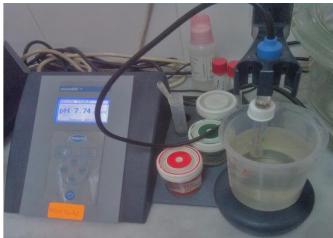
Figure III-1 : appareil de mesure de pH et de température.
