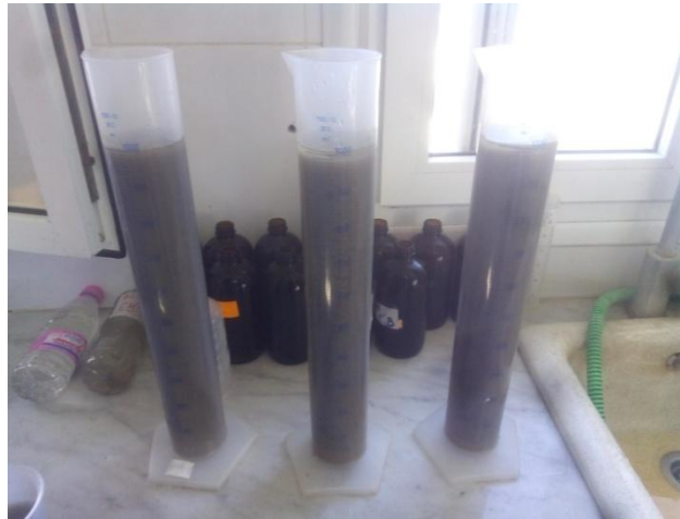
Figure III-13 : test de décantation.
