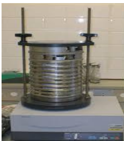
Figure II-23:les tamis utilisé dans l'analyse granulométrique
