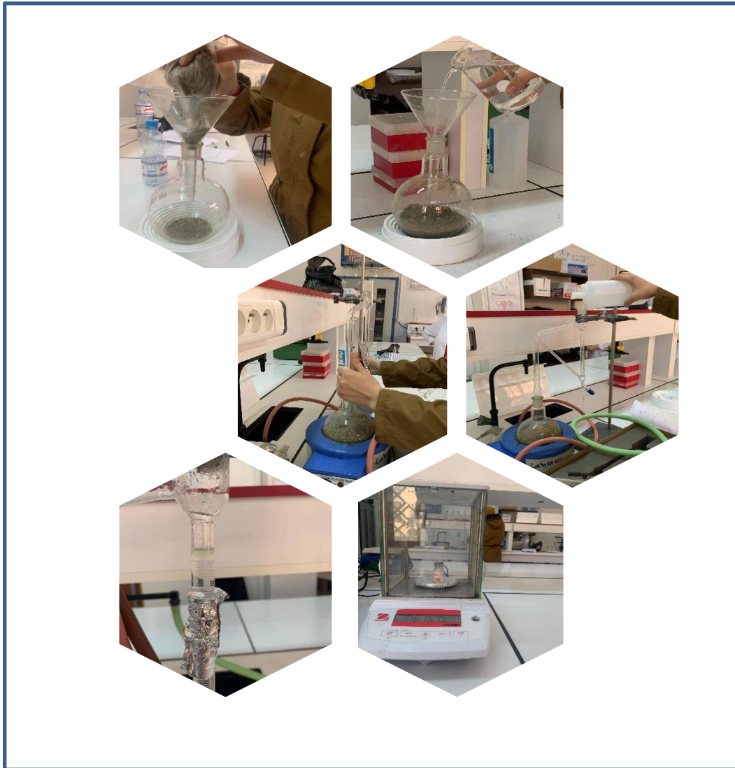
Figure 09 : Etapes d'extraction de l'huile essentielle d' origanum majorana
