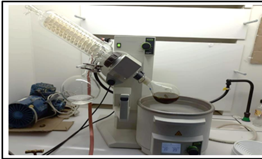
Figure 28 : Etapes de l'Evaporation (photos personnel)
