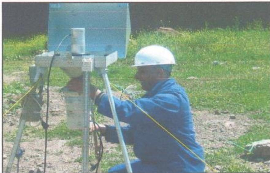
Figure 2. 13 : Photo montrant l'étalonnage de l'échantillonneur de poussière
