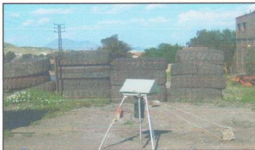
**Figure 2.15 : Photo montrant l'échantillonneur de poussière à proximité de la cité centrale**
