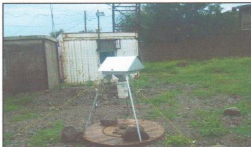
**Figure 2.14 : Photo montrant l'échantillonneur de poussière à proximité de la cité saint -barbe**
