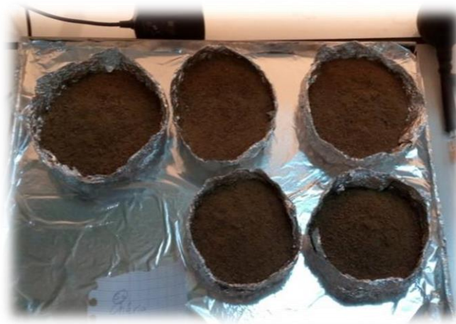
Figure 27: Échantillons du sol après le séchage à l'étuve (photo. Personnelle, 13 Janvier 2022).
