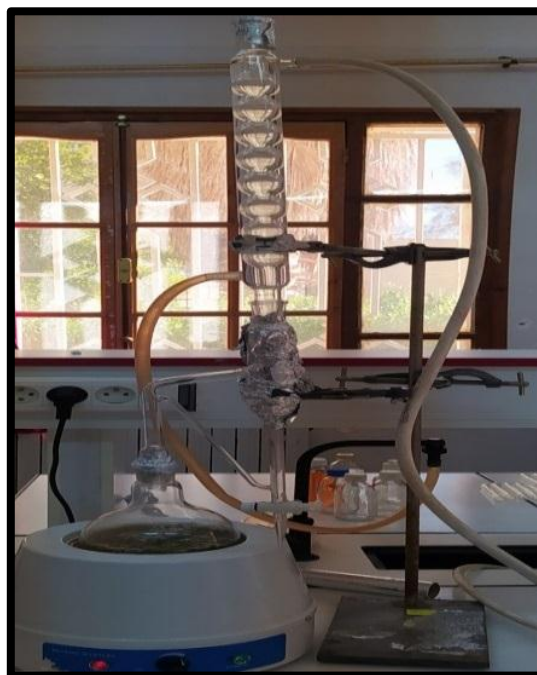
Figure 23: Dispositif de l'hydrodistillation de type Clevenger.
